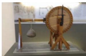
2-⑥ 持ち上げるレバーの動きを回転運動に変える機械
