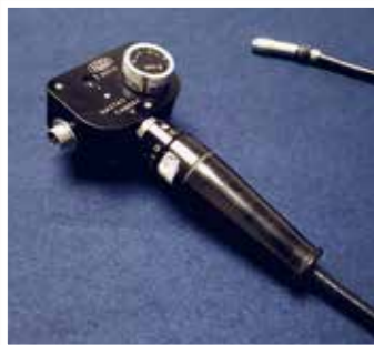
●ガストロカメラV型(健康と医学の博物館所蔵) 1960年11月に発売され、当院で実際に使用されていた胃カメラ。全体的に柔軟な材質で外径8.5mmと細く、患者の苦痛が軽減された。
