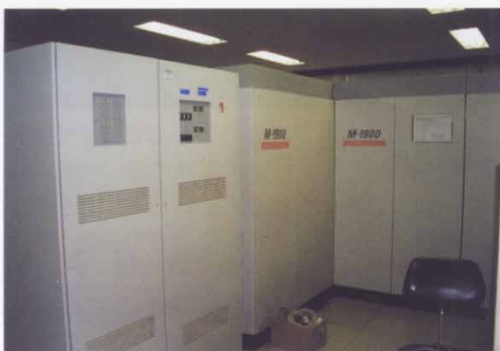
写真5 全診療データを管理するホストコンピュータ（富士通 M1900） ディスクは約150ギガバイトで、10年分の検査・処方データを蓄積している
