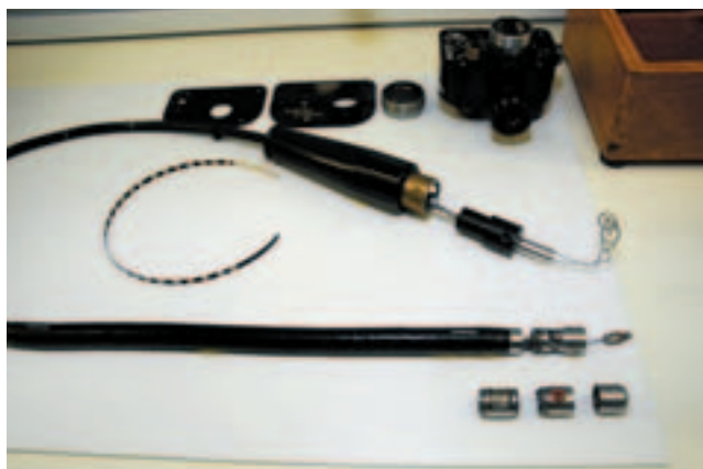
4. 胃カメラの構造部（左端は、使用されていた6mmフィルム）
