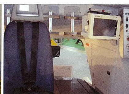
図6 医師の座席のすぐそばに生体監視装置と酸素ガス供給、吸引システムがある
