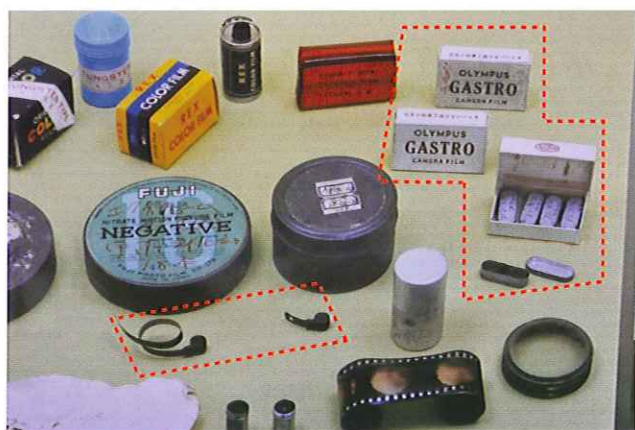
写真5 さまざまなフィルム 点線内が胃カメラのフィルムとマガジン 35mmフィルムに比べて極めて小さい
