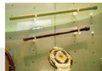
図12：ガリレオが自ら作成し、使用した屈折型天体望遠鏡(×30)
