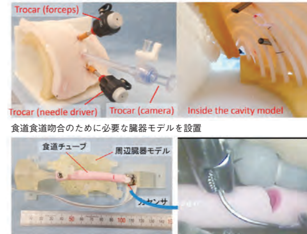
図3：食道閉鎖症モデルを用いた内視鏡下縫合手技評価 患者CTデータより新生児の胸腔や実際の状況を再現
