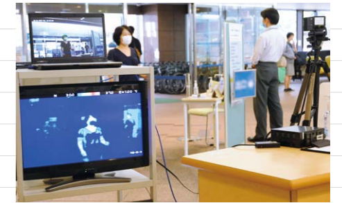
発熱の有無を確認するサーモグラフィ(外来診療棟入口)
